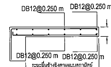
แบบขยายรายละเอียดการเสริมเหล็ก แผ่นพื้น คสล. CS3
